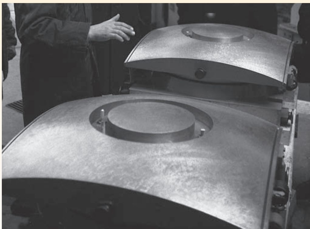
Гидростатические подушки телескопа перед установкой.
