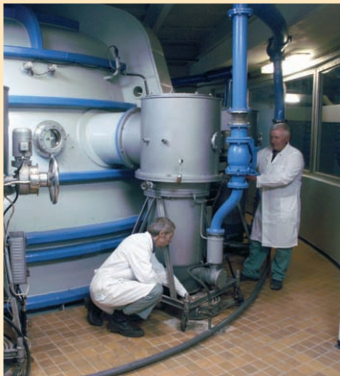
М.П. Казанцев и В.М. Черепков готовят к работе вакуумную установку алюминирования зеркала.
