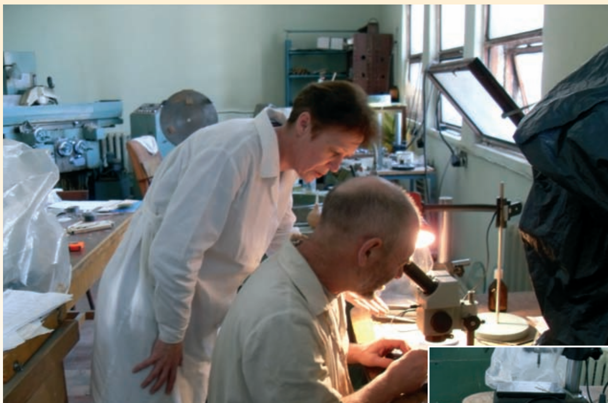
Оптический участок макетных мастерских (ММ). Контроль качества линзового растра для блока панорамной спектроскопии нового прибора «SCORPIO». У микроскопа – Е.И. Перепелицин и Н.С. Ломакина
