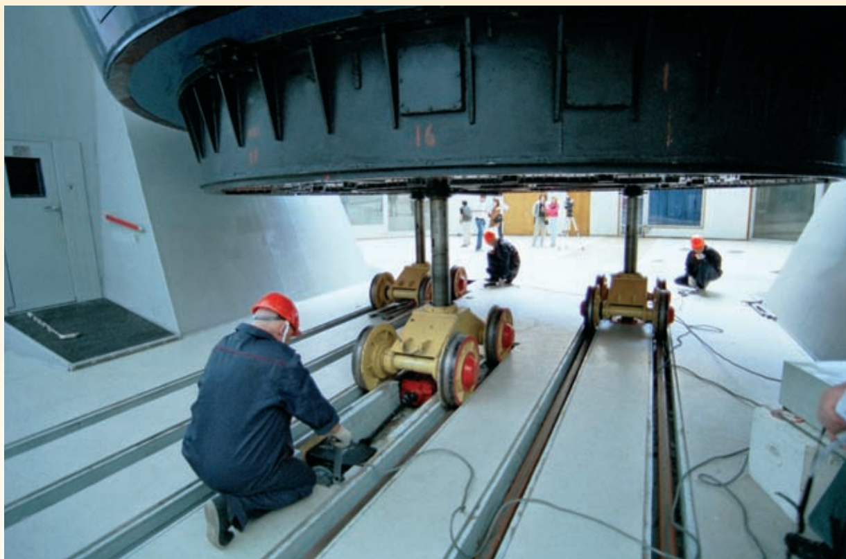
Установка главного зеркала БТА на транспортные тележки перед алюминированием. Работу ведут сотрудники механического участка СЭК БТА.
