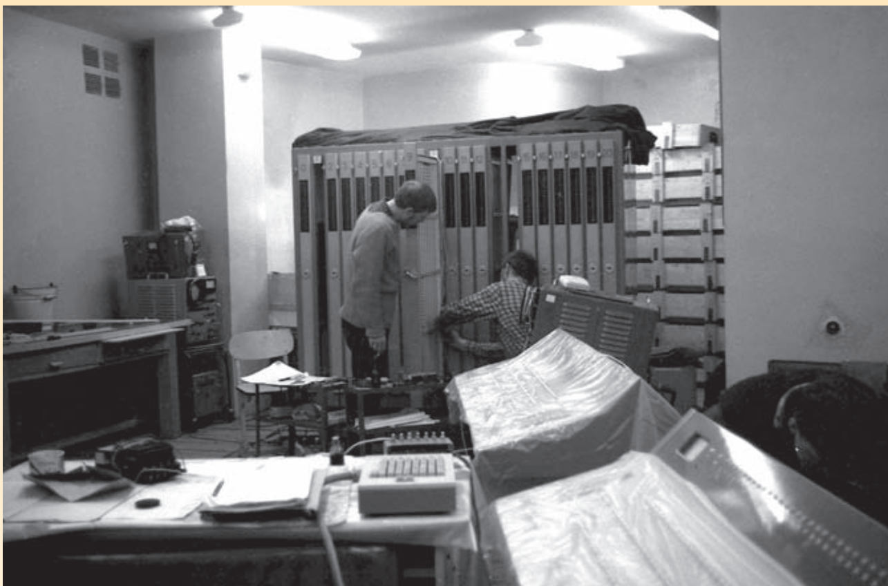
Монтаж ЭЦУМ – электронной цифровой управляющей машины телескопа и ЦПУ – центрального пульта управления.
