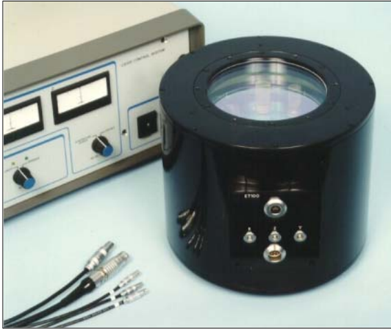
Рис. 15. Слева – сканирующий пьезоэлектрический интерферометр Фабри-Перо. Справа – изображение полученное на SCORPIO с новым интерферометром.
