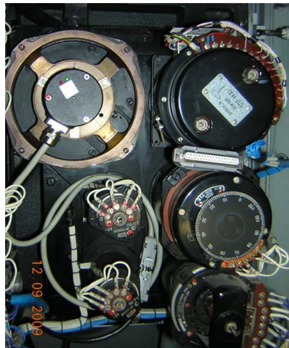
Рис. 12. Слева – новый смонтированный узел «PEP Z», справа – 23-разрядный датчик оси «Z».
