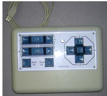
Рис. 13. Слева – плата пульта коррекции положения телескопа с подключением по USB-порту; справа – сам пульт коррекции.
