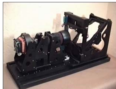
Рис. 18. Оптическая схема отдельного канала широкопольной мониторинговой камеры Mini-MegaTORTORA. Внешний вид отдельного канала камеры Mini-MegaTORTORA в сборке.
