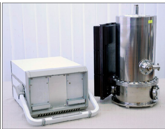
Рис. 19. Примеры конструктивного исполнения ПЗС-систем. Слева - система с камерой, охлаждаемой посредством Cryotiger; справа - система с камерой, охлаждаемой жидким азотом.
