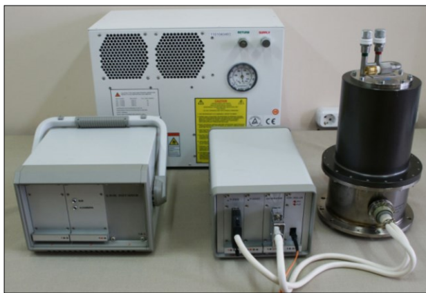
Рис. 19. Примеры конструктивного исполнения ПЗС-систем. Слева - система с камерой, охлаждаемой посредством Cryotiger; справа - система с камерой, охлаждаемой жидким азотом.
