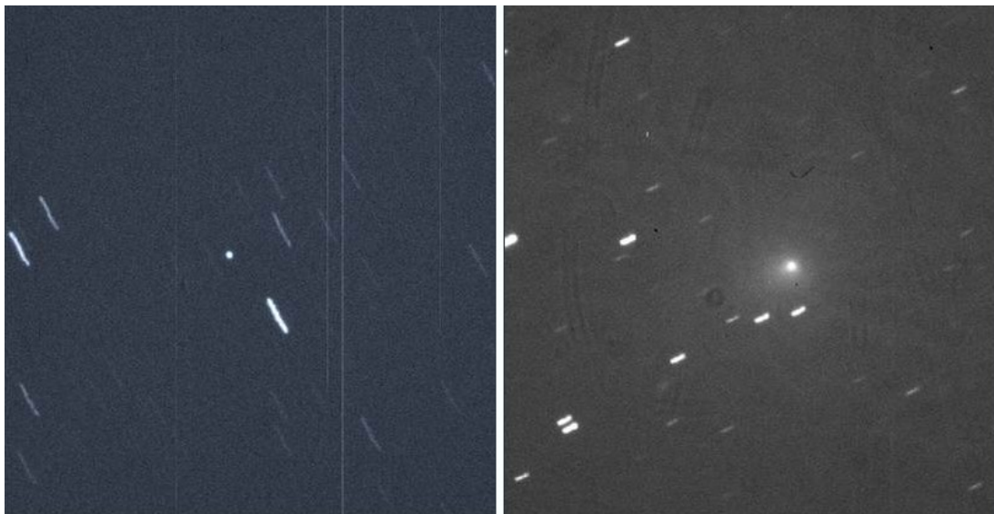
Рис. 11. Наблюдения в режиме слежения с помощью новой автоматизированной системы управления (АСУ) телескопа Цейсс-1000. Слева - спутник GPS PRN-13; справа - комета 154P/Brewington.
