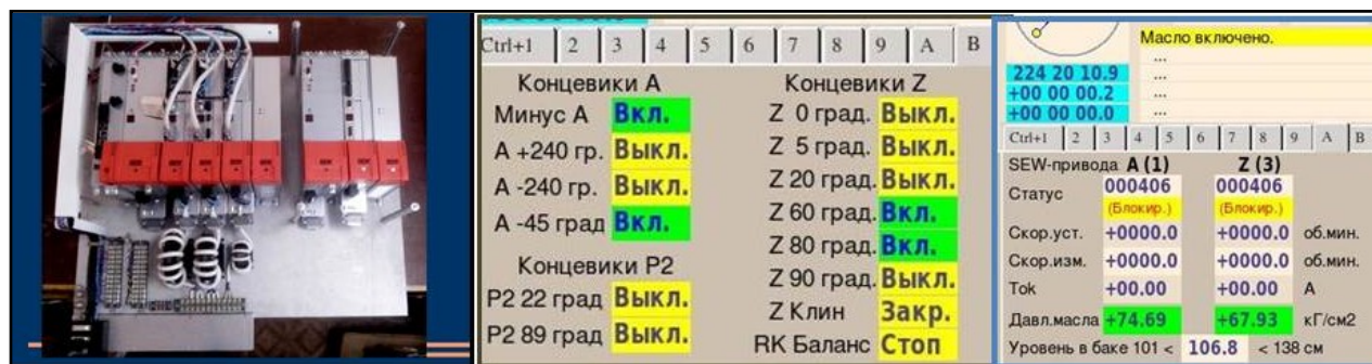
Рис. 13. Слева - щит управления приводами основных осей телескопа в собранном виде перед установкой на телескоп; в центре – окно контроля состояния концевиков, справа – контроль давления в маслосистеме в интерфейсе оператора.
