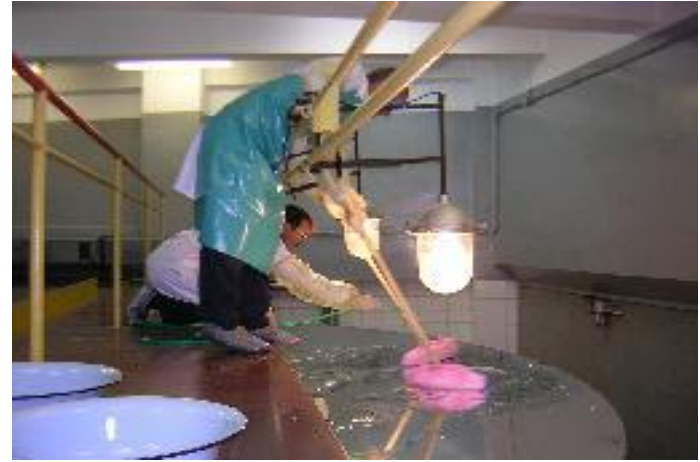
Снятие старого алюминиевого слоя
