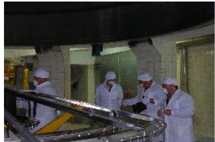
Снятие старого алюминиевого слоя
