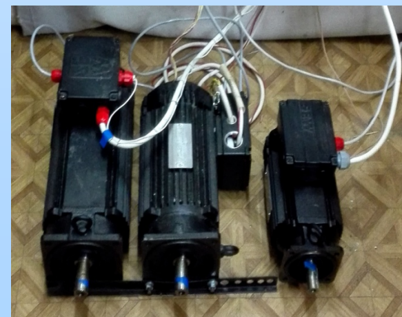
Синхронные двигатели переменного тока аналогичные установленным в приводах БТА
