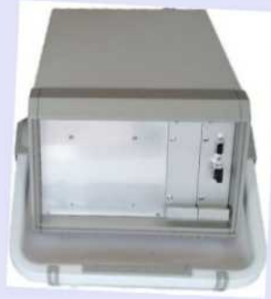
Рис. 1 – Внешний вид ПЗС-систем: криостат с контроллером Dinacon-5 и блок питания
