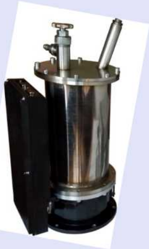
Рис. 1 – Внешний вид ПЗС-систем: криостат с контроллером Dinacon-5 и блок питания
