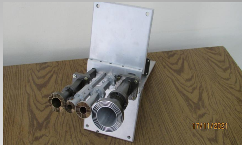
Входные тракты радиометров на 2.1, 1.0, 1.4 и 3.7 см
