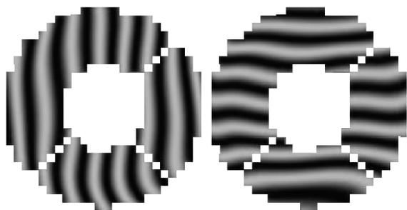
Рис. 9. Синтетические интерферограммы системы (главное + вторичное зеркала) в одном проходе после юстировки.
