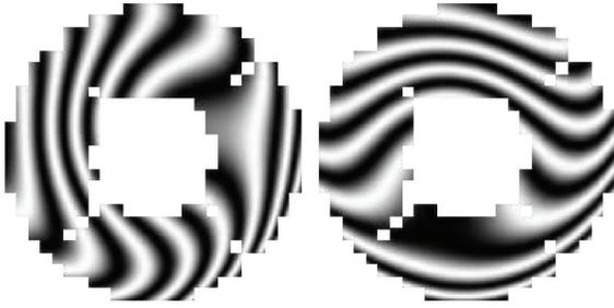
**Рис. 2.** Синтетические интерферограммы системы в одном проходе перед началом юстировки ( $PTV=2.1\lambda$ ,  $RMS=0.37\lambda$  при  $\lambda=532$  нм).
