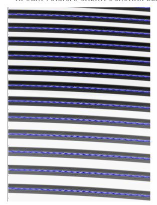
Рис. 2. Пример определения центров эшелле-порядков процедурой, настроенной на параметры спектрографа HRS. Приведена небольшая часть двумерного спектра лампы плоского поля. Найденные позиции центров эшелле-порядков показаны квадратиками. Видна сложная структура каждого порядка.
