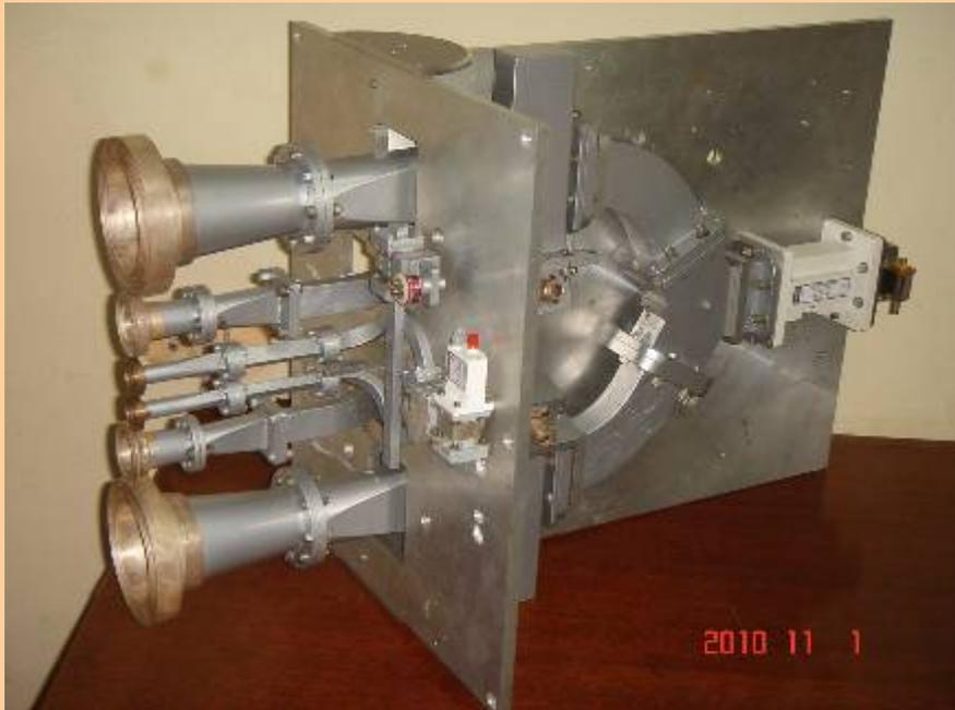
• Проведена модернизация спектрального комплекса на длине волны 6 см, в результате которой расширена полоса Фурье спектроанализатора до 60 МГц, улучшены шумы и линейность приемной системы.
