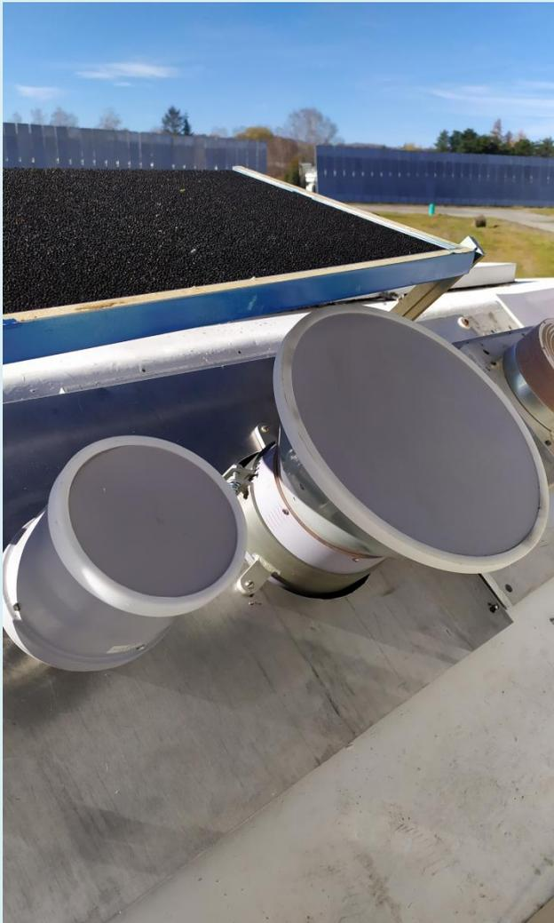
**1. Двухдиапазонная рупорная антенна с совмещенным фазовым центром:**
