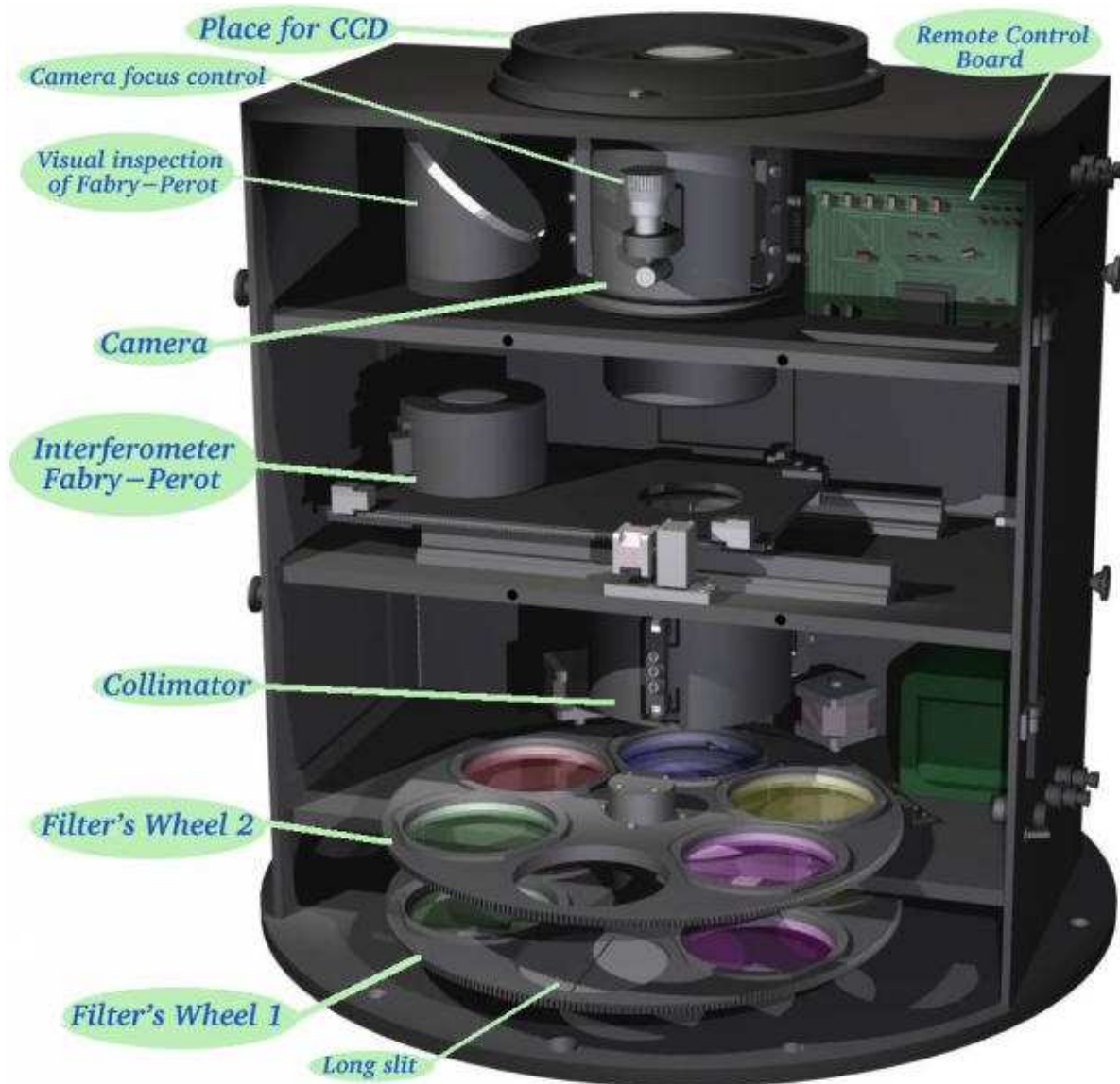
Рис. 1: Устройство редуктора светосилы
