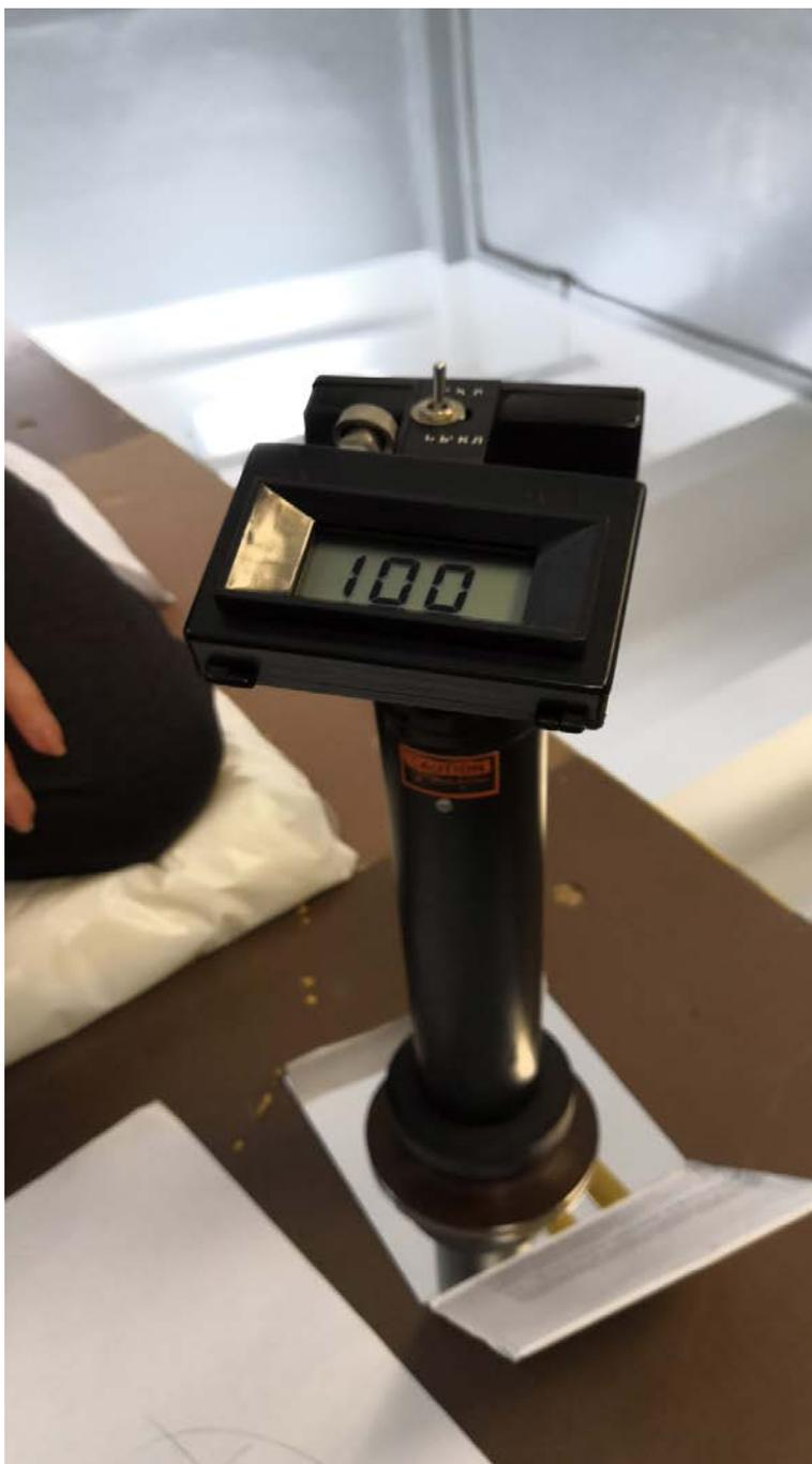
Рисунок 5. Коэффициент отражения эталонного образца на длине волны 640нм
