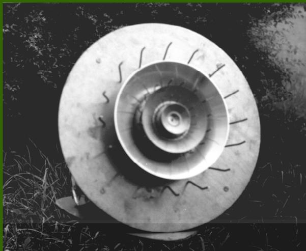
**FIG. 03 Трехчастотный совмещенный первичный облучатель В.Н. Дикого**
