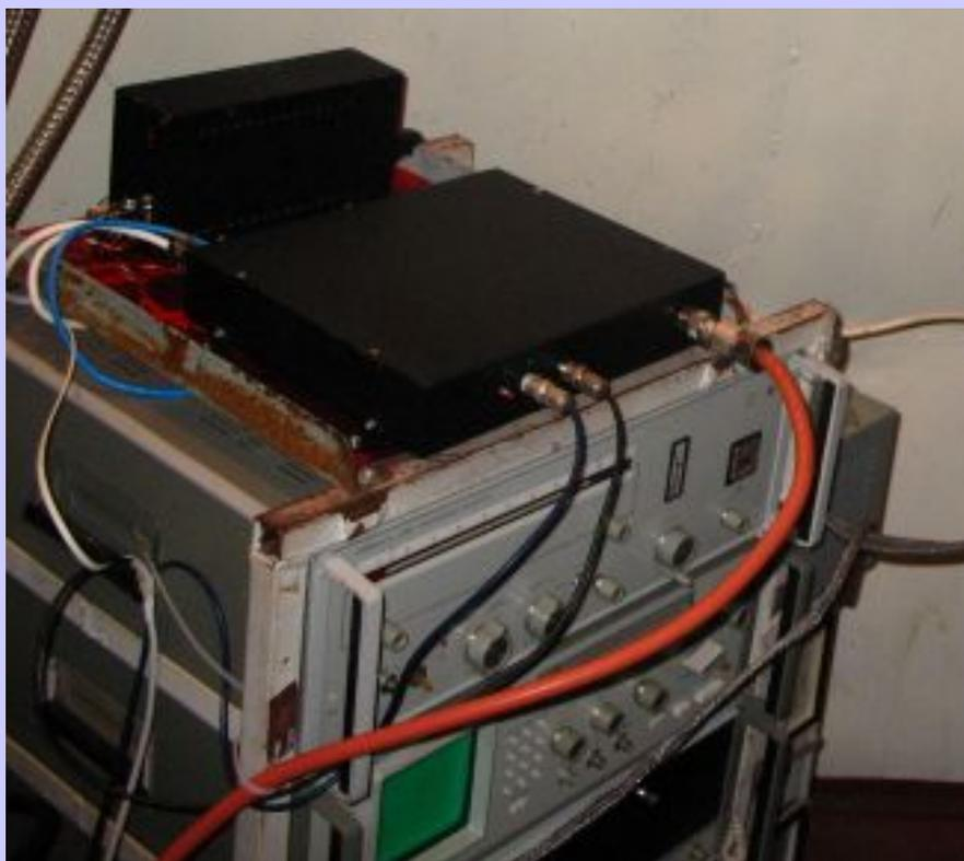
Рис. 1. Внешний вид модуля ЦРМС, установленного в надзеркальной кабине радиотелескопа РТФ-32
