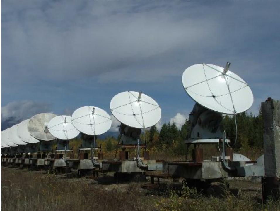
10-антенный макет многоволнового радиогелиографа диапазона 4-8 ГГц. Антенны макета установлены на краях антенной решетки ССРТ
