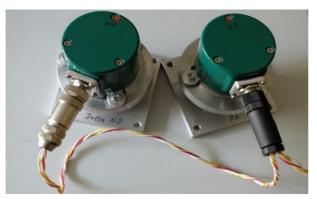
На телескопе установлены угловые датчики фирмы *FRABA* подключенные прямо к CAN-шине. Протокол доступа — *CANopen* (DS301V4.0 Profile:DS406, C6-class). Для обмена с ними разработан *Java*-класс *ZeissEncodersCAN* имитирующий пакеты протокола *CANopen*.
