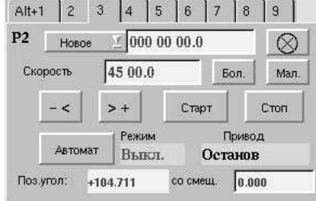
Добавлены окна **Поз. угол** и **со смещ.**. Они предназначены для определения позиционного угла щели спектрографов в ПФ. Расчет производится по формуле:
