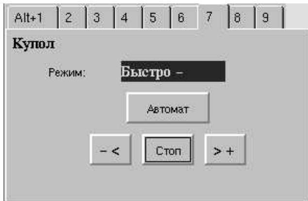
Вариант панели **Купол** предназначен для ручного или автоматического управления приводами купола. Этот вариант можно использовать только когда подключены схемы управления куполом через УСО компьютера (автор Данилов В.Г.). Этот вариант содержит следующую информацию:
