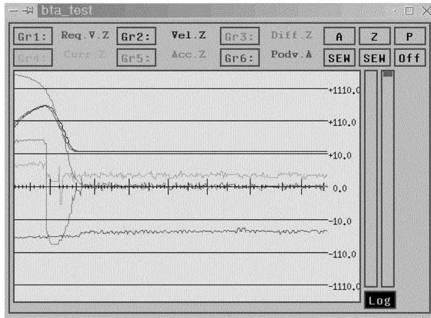
При выборе варианта теста ....**графики** появляется окно теста с тремя движущимися графиками разного цвета. Кнопки <Gr1:>, <Gr2:>, <Gr3:>, <Gr4:>, <Gr5:>, <Gr6:> вызывают меню с помощью которого к данному графику подключается одно из значений.
