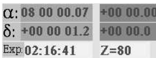
Это информация о текущих (откорректированных) координатах. Рядом расположены поправки коррекции  $\Delta\alpha$  и  $\Delta\delta$ . В нижней строке находится название ближайшего концевика и время движения к нему (для текущих координат).
