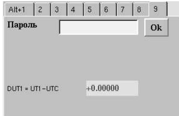
При запуске интерфейса на одном из компьютеров АСУ, кроме **acs1** и **acs5**, он стартует в режиме **Operator** (уровень 4) и на экран выводится как окошко для ввода паролей так и интерфейс установки новых паролей. Страна под окошком для ввода пароля показывает поправку времени для пересчета координат объекта.
