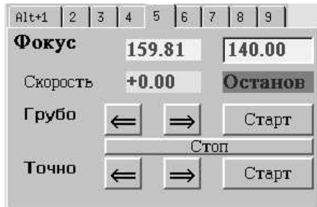
Вариант панели **Фокус** предназначен для управления приводом фокусировки. На панели показано текущее значение фокусировки, скорость и состояние привода:
