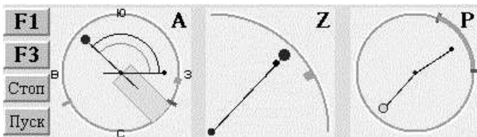
Кнопки **F1**, **F3**, – эквивалент функциональных кнопок для любителей работы мышкой. Кнопка **Стоп** – функциональная кнопка **F5**. Кнопка **Пуск** – функциональная кнопка **<F12>**.
