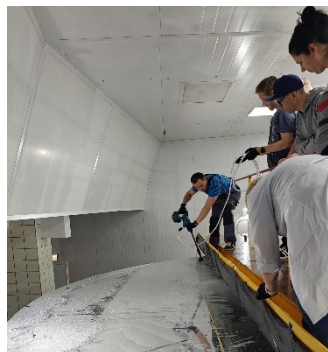
Подготовка ГЗ к алюминированию: мойка и травление старого отражающего слоя
